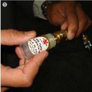
1 Realizar el montaje del adaptador 90764 000 114 en el envase del aditivo fluorescente 90892 764 010.
