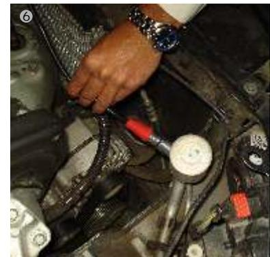
6 Usando las gafas especiales, iluminar con la lámpara todo el circuito del gas refrigerante, especialmente donde se sospecha que existen fugas.
