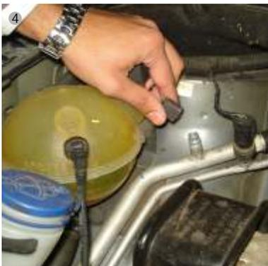
4 Sacar la tapa plástica protectora y montar el otro extremo del adaptador. Con el motor detenido, realizar la inyección del producto dentro del sistema. Desconectar el equipo y encender el motor.
