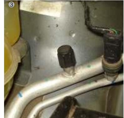
3 Localizar en el vehículo la válvula de carga de gas del circuito de refrigeración.
