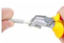
Doblar ligeramente el cable para seccionar la funda y estirar de ella para extraerla completamente.
