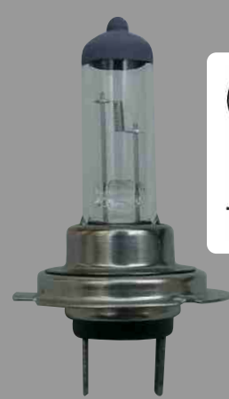
Cód. 80720 116 9 H7, 12V 55W Zócalo: PX 26d Uso: alta o baja
