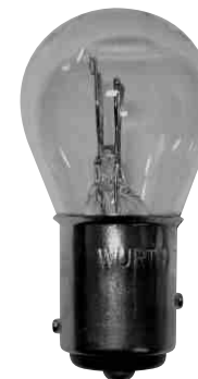
Cód. 80720 134 1 12V 21/5W patas desparejas Zócalo: BAY 15d Uso: stop y posición
