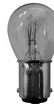
Cód. 80720 134 4 12V 21/5W patas parejas Zócalo: BA 15d Uso: stop y posición
