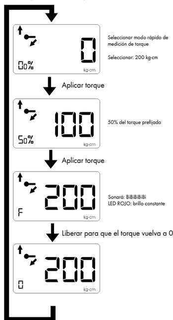
Modo progresivo de medición de torque
