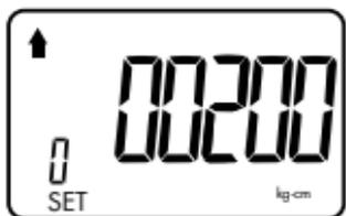
Modo pico de medición de torque
