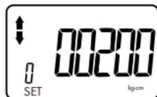
Modo seguimiento de medición de torque
