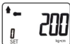
Seleccionar Modo pico de medición de torque
