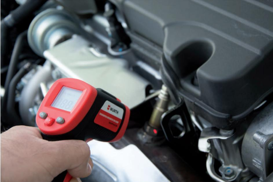
**Para la medición sin contacto de la temperatura de superficies, con puntero láser integrado. Ideal para áreas de difícil acceso o peligrosas.**
