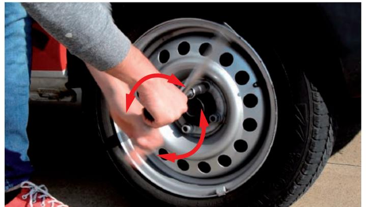
Práctica llave cruz. Permite girar la herramienta con una mano mientras se sujeta el mango fijamente con la otra. El mango fijo hace que el eje gire en sentido horario o antihorario facilitando la extracción o colocación de bulones y tuercas.
