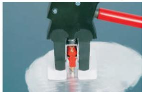
Apoyo estrecho para pequeñas abolladuras y cortes.
