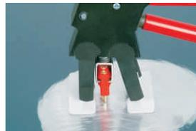
Diferentes posiciones de las patas, permiten la adaptación de ángulo y altura.
