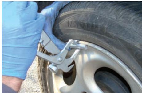
Diseño de pinza ideal para montaje y desmontaje del contrapeso.
