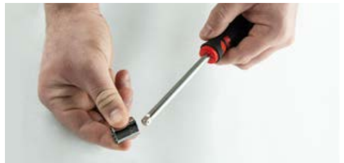
Con destornillador de 1/4" para utilizar con tubos.
