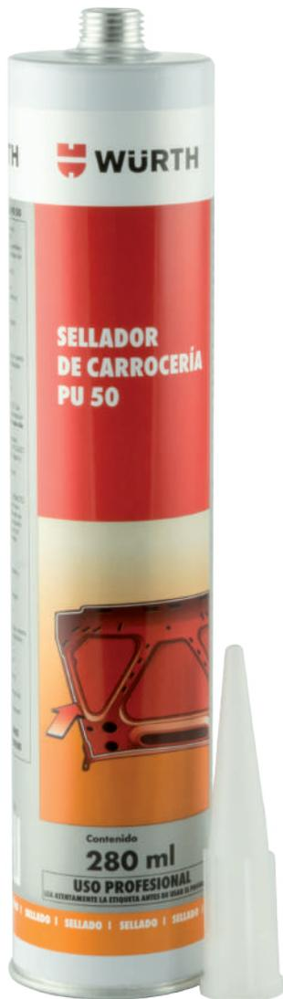
**Sellador de un sólo componente en base poliuretánica de módulo alto, que cura con la humedad atmosférica. Forma una unión flexible y duradera con muy buena adhesión en la mayoría de los materiales.**
