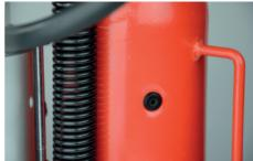
inferior del orificio de llenado y purgue el aire del sistema hidráulico como se describe anteriormente. En caso de que luego de la purga el nivel vuelva a bajar, complete con más aceite hidráulico y luego reemplace el tapón de llenado.
