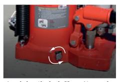
■ ¡ADVERTENCIA! La apertura y cierre repentino de la válvula de liberación puede provocar el impacto de las cargas elevadas. La sobrecarga resultante puede causar fallas en el sistema hidráulico que podrían causar lesiones personales graves y/o daños a la propiedad.
