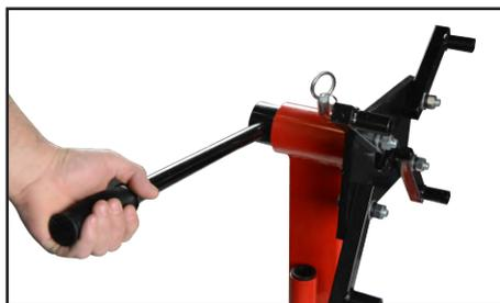
Traba de seguridad (permite distintas posiciones e impide el giro involuntario del cabezal).
