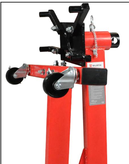
4 brazos con guías, que permiten una adaptación a distintos tipos de motores.
