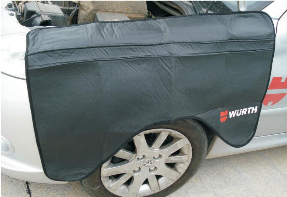
Protege los guardabarros de los daños durante los trabajos de reparación y mantenimiento.
