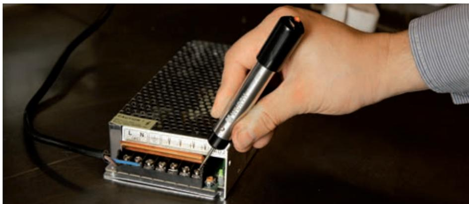
Sostenga el probador por el barril de metal y coloque la aguja o punta en el conector o cable (perfore el aislamiento si es necesario).
